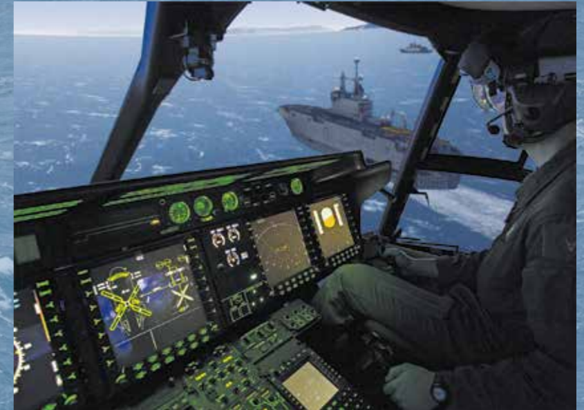
Cockpit du simulateur Sogitec NH90 Marine avec nouvelle génération d'imagerie de synthèse de Sogitec, Apogée™ 7, projetée sur écran sphérique très grand champ et à haut gain.
